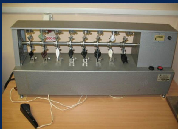
ИПК-2м для испытания устойчивости к изгибу материала
