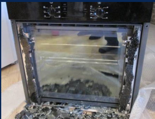
Разрушение закаленного стекла при нагреве духового шкафа
