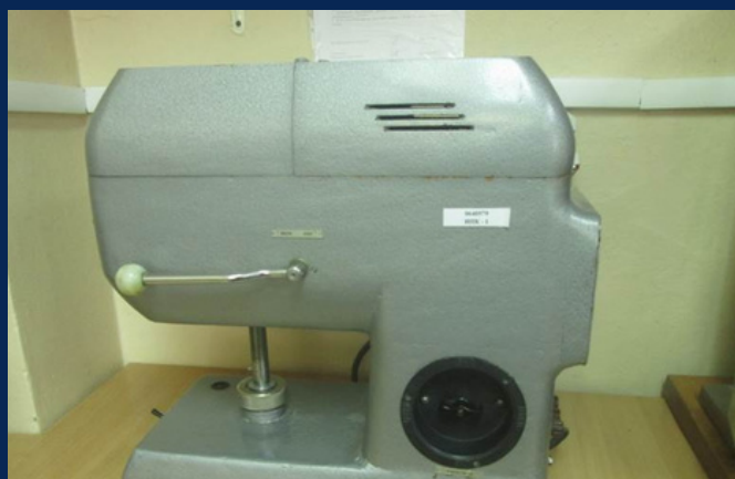
ИПК-1 для испытания устойчивости покрытия материалов к истиранию
