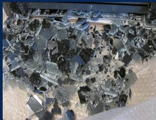
Разрушение закаленного стекла при нагреве духового шкафа
