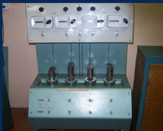
ИПК-2м для испытания устойчивости к изгибу материала
