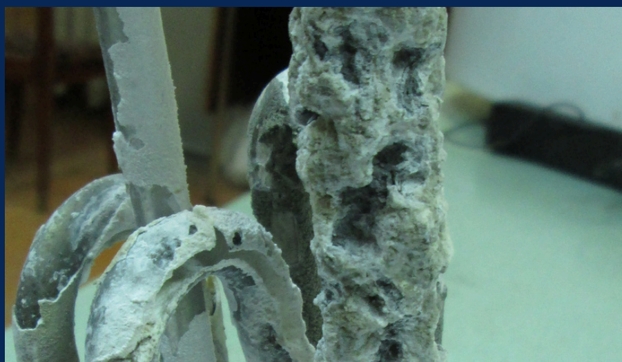
Разрушение тена водонагревателя
